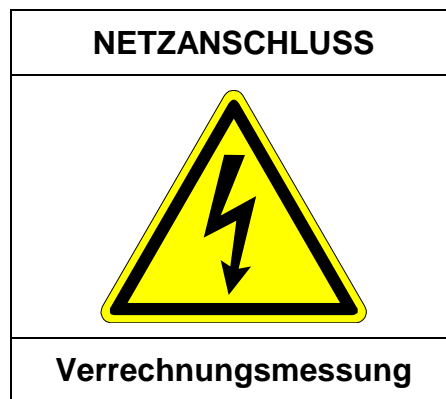
Bild 2 - Musterschild zur Kennzeichnung von A- und AV-Schränken
